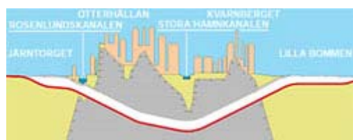
Figur 3.5 Götatunneln i profil ( www3.vv.se/gotaleden/bygget.asp , 2004-09-20)
