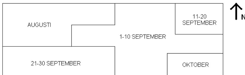
Figur 3.37 Översikt över pålningsordning
