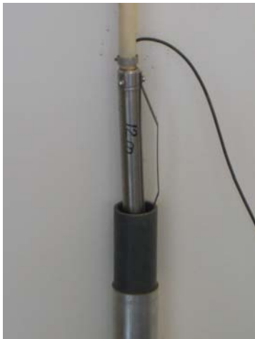
Figur 3.3 Inklinometer, delvis nedfört i mättrör
